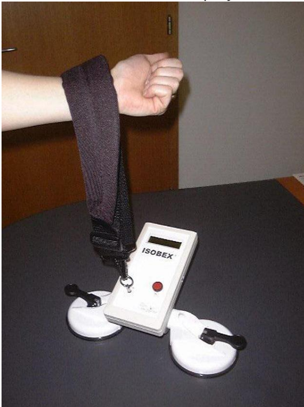
Figura 11. Dinamómetro isométrico Isobex (Berna, Suiza).
